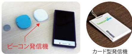
デバイスから発信された電波(Bluetooth)をスマートフォン(アプリ)が受け取り、スマートフォンの通信を使ってサーバ(クラウド)にデータを送ります。定期的な電波発信と受信する電波の強弱によるデバイス間の距離測定で、例えば、お店の棚につけられたビーコンから、スマートフォンを持っている人が1m以内にいる、10分滞在している(商品購入を迷っている)、というようなことが分かります。
