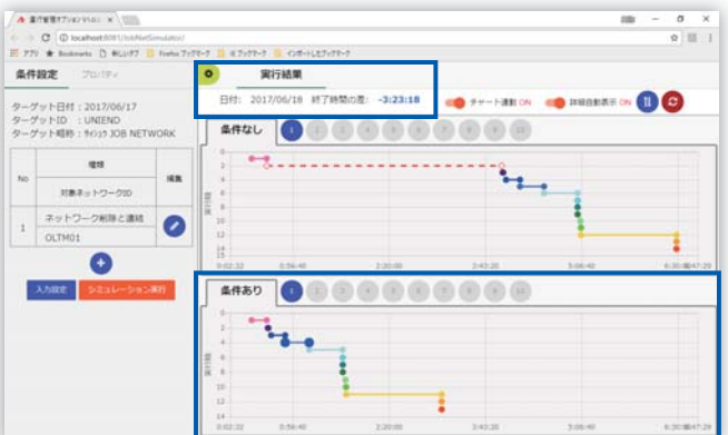
シミュレーション実行で条件設定したクリティカルパスの表示と、終了時間の差を確認
